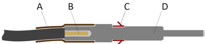
A : Термоусадочная или изолирующая трубка
