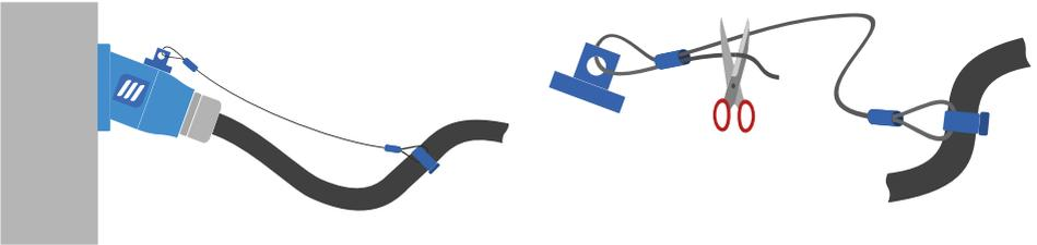
GUÍA PARA HILO : Algunas empuñaduras incluyen una guía que permite un ángulo óptimo de tracción del dispositivo de eyección.
