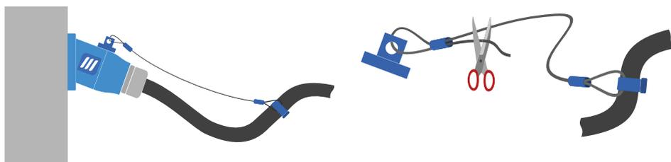
GUIDA CAVETTO : Su alcune impugnature è previsto un guida cavetto, che garantisce un'angolazione ottimale della trazione del dispositivo di espulsione.
