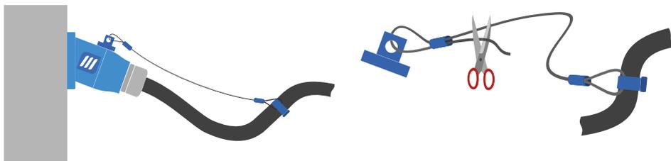
УШКА : Некоторые ручки оснащены пластиковыми ушками. Они обеспечивают оптимальный угол натяжения натяжного шнура на механизме отпуска защелок.
