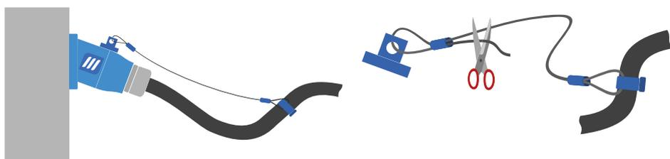
GUIDE FILIN : Certaines poignées sont munies d'un guide filin. Ce guide filin permet que la traction soit exercée sur le dispositif d'éjection avec un angle optimal.
