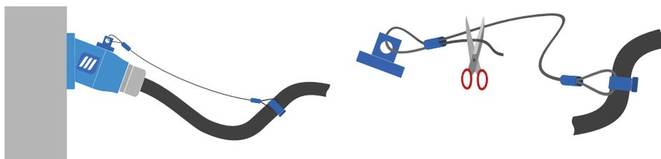
KORDELFÜHRUNG : Bei einigen Griffen wird eine Führung geliefert. Diese sorgt dafür, dass der Zug auf den Auswurf-Mechanismus in einem optimalen Winkel erfolgt.
