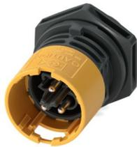
Embases paroi avant, Famille d'articles: PRC 20, coloris: noir, nombre de pôles: 3, section de fil min.: 0,5 mm<sup>2</sup>, section de fil max.: 2,5 mm<sup>2</sup>, tension de référence: 400 V, courant de référence: 20 A, Type de raccordement: Raccordement vissé, Réglage possible du déverrouillage : 1. avec un outil ou 2. à la main
