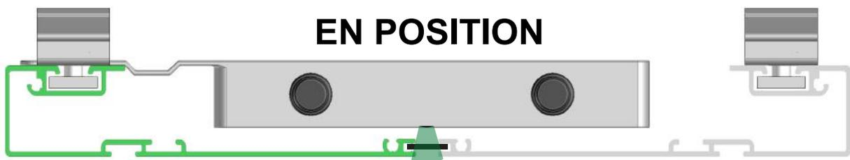
**Note :** les bouchons EBPV75 se positionnent l'un contre l'autre. Réalisez une découpe sur le joint présent sur le PPV75 au niveau des LED
