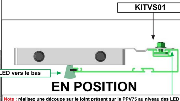
**Note :** réalisez une découpe sur le joint présent sur le PPV75 au niveau des LED
