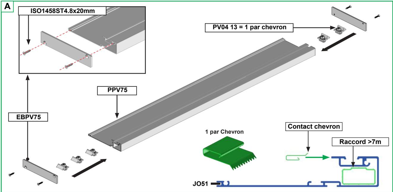
**B** Réalisez les mêmes opérations du paragraphe 9 pour la pose du 2nd PPV75 et le plaquer contre le 1er.
