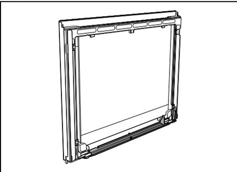
4. Après le nettoyage, repositionnez la vitre interne dans les pattes. Veillez à centrer et à encastrer les 4 pivots dans leurs logements sur la porte, aidez-vous des joints placés à
