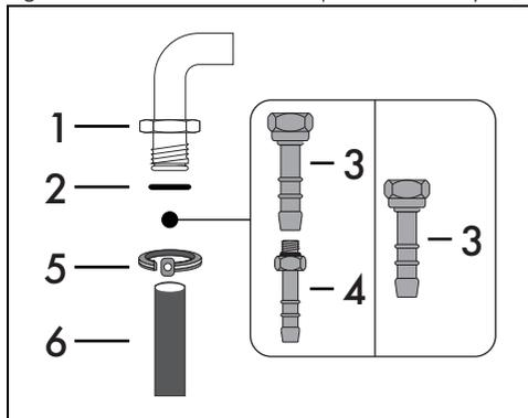
Vissez minutieusement l'embout 3 sur le raccord du gaz 1 (filet  $\frac{1}{2}$ " ISO 228-1) de l'appareil en interposant le joint 2. Suivant le diamètre du tuyau du gaz utilisé, on peut également visser l'embout 4 sur l'embout 3.
