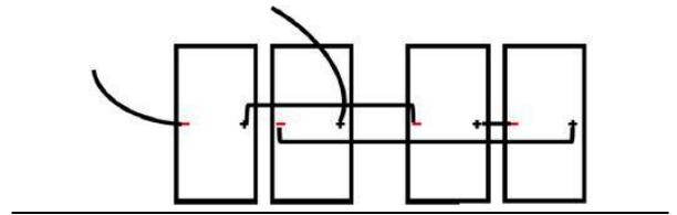
La distance maximale entre deux cadres de modules adjacents doit être de 50 mm (1,96 pouce) pour le côté avec les pinces de montage, et de 25 mm (0,98 pouce) pour le côté sans pinces de montage, afin de respecter le schéma de câblage du système.
