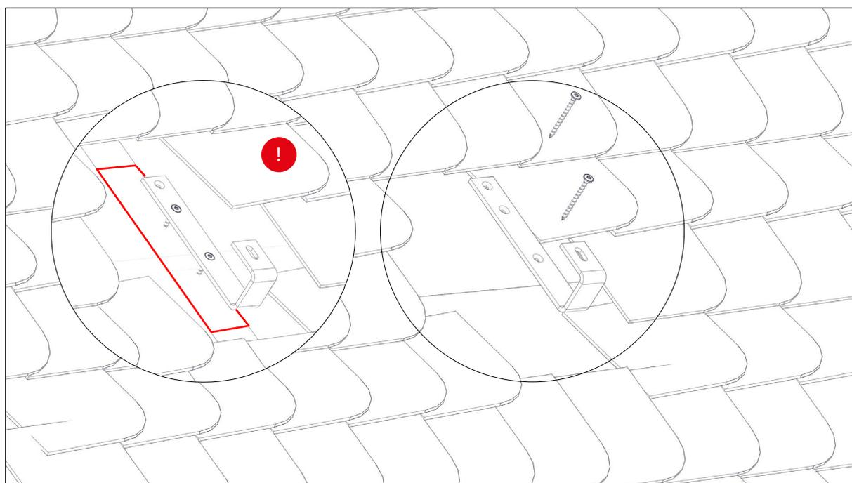
2B : Pose sur la sous-structure de la couverture – pose directe sur le litage (ou liteauage)
