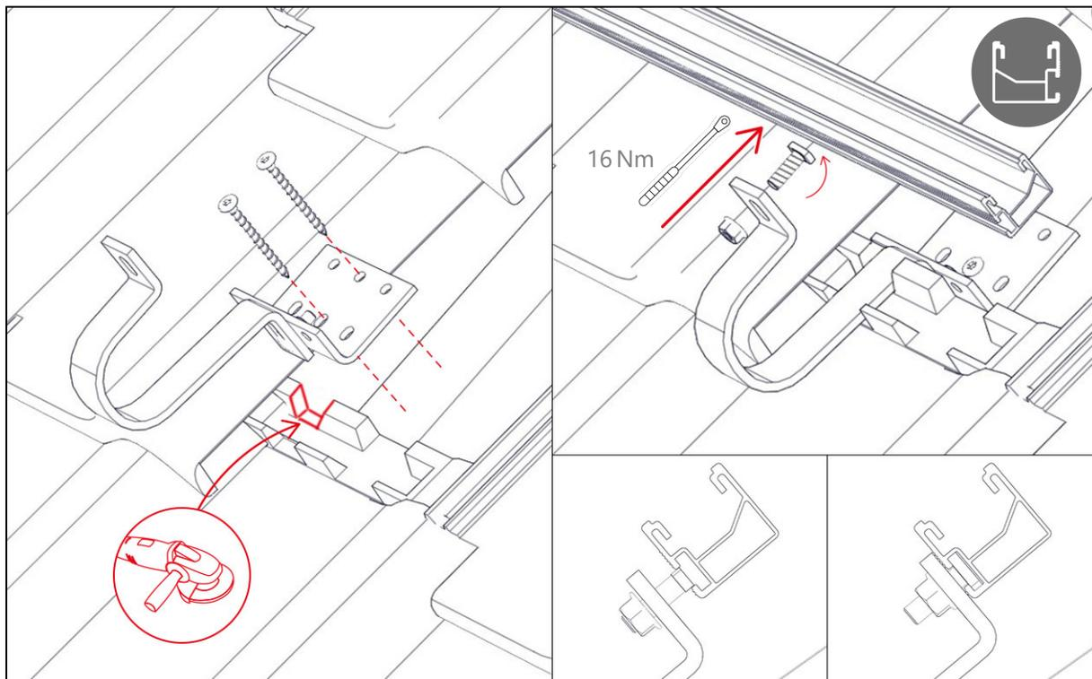
SolidHook Vario 2 avec SingleRail en utilisant le L adapter
