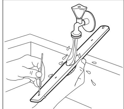
5. Pour réinstaller le bras d'aspersion (C), insérez la fixation (B) dans le bras d'aspersion et insérez-le dans le tuyau d'alimentation (A) en le tournant vers la droite. Assurez-vous que la fixation se verrouille correctement dans la bonne position.
