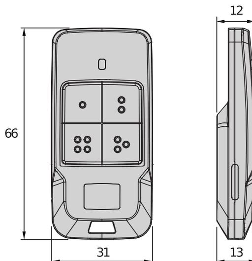
Gamme de radiocommandes composée de modèles à deux et quatre canaux, tous disposant d'une LED rouge ponctuelle, disponibles en quatre couleurs et avec possibilité de personnalisation à l'avant. Elles prennent en charge la nouvelle technologie U-Security et sont alimentées par une pile bouton de 3 V facile à trouver.
