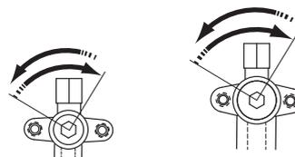
Dans le sens inverse des aiguilles d'une montre pour ouvrir.
