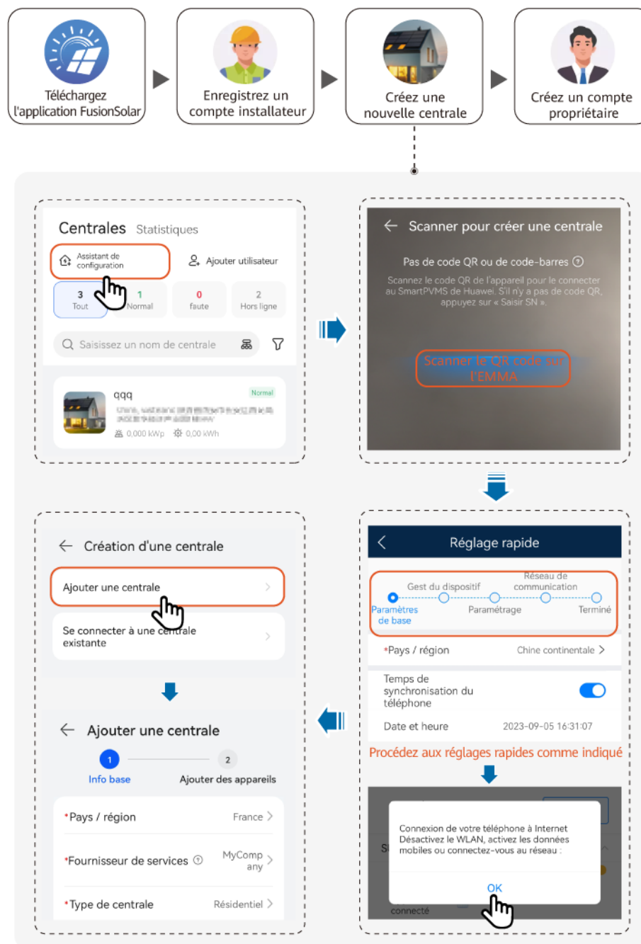
Figure 6-1 Déploiement d'une nouvelle centrale
