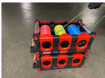
(5) Empilez les outils pour en tirer plusieurs fils au même temps
