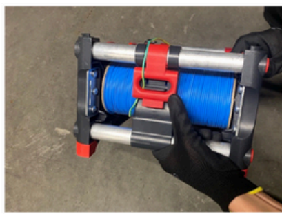
(6) Bloquez vos fils après vos installations avec le guide-fil
