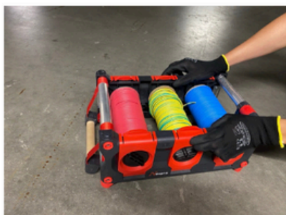
(3) Coincer la bobine avec le système de verrouillage
