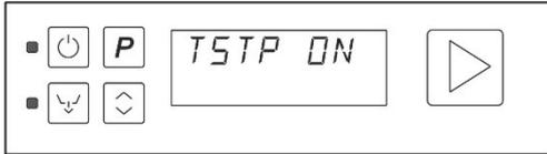
**Réglé sur « on » = température minimale de lavage et de rinçage pour la cuve et le surchauffeur telle que définie, quelle que soit la température de l'eau en entrée; la durée nominale du cycle pourrait être prolongée de quelques secondes.**
