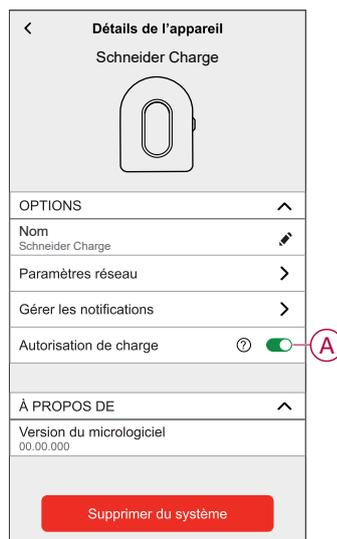
Lorsque cette option est activée, lors de la connexion du chargeur à un VE, appuyez sur **Autoriser la charge** (B) dans le panneau de commande pour lancer le processus de charge.
