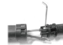
**Krok 4** Našroubujte otočnou matici na závitové pouzdro. Tím se utěsní konektor AC napájení a odlehčí se tah kabelu AC napájení. Přitom držte vložku pouzdra pevně za zajišťovací kryt. Tím je zajištěno, že otočnou matici lze pevně našroubovat na závitové pouzdro.
