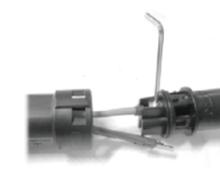
**Passo 4** Avvitare il dado sul manicotto filettato. Questo sigilla il connettore AC e garantisce lo scarico di tensione per il cavo AC. Per farlo, impugnare saldamente l'inserto della boccola dal tappo di chiusura. In questo modo sarà possibile avvitare saldamente il dado sul manicotto filettato.
