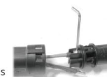
**Schritt 4** Schrauben Sie die Schwenkmutter auf die Gewindehülse. Dies dichtet den Wechselstromanschluss ab und sorgt für eine Zugentlastung des Wechselstromkabels. Halten Sie dabei den Buchseneinsatz an der Klemmkappe fest. Dadurch wird sichergestellt, dass die Schwenkmutter fest auf die Gewindehülse geschraubt werden kann.
