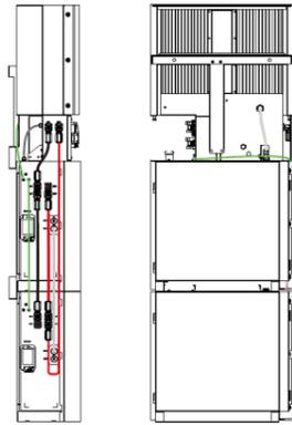
**Passo 5** Chiudere i coperchi delle batterie e collegare i connettori PV-MC4 al sistema (collegare le stringhe su entrambi i lati).
