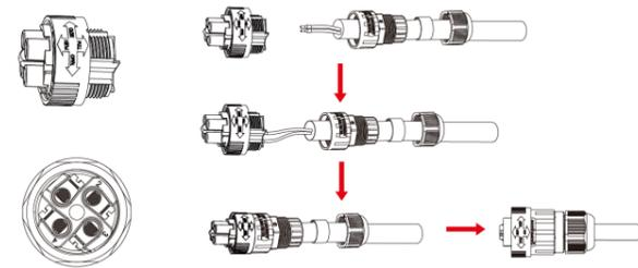
**Passo 2** Installare il componente impermeabile e avvitare il dado della guaina impermeabile
