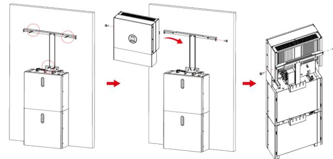
**Étape 1** Accrochez l'onduleur aux panneaux de montage, ajustez l'ensemble du système et assurez-vous que la batterie et l'onduleur sont bien accrochés aux panneaux et aux équerres de fixation.
