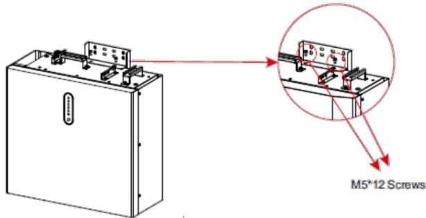
**Étape 3** Positionnez la batterie parallèlement au mur et utilisez une perceuse de 10 mm de diamètre pour percer des trous à une profondeur d'environ 70 mm dans le mur pour la fixation ultérieure des plaques de montage.
