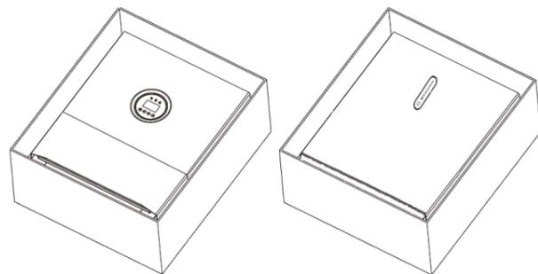
**Trinn 2** Monter batterimonteringspanelet på batteriet.
