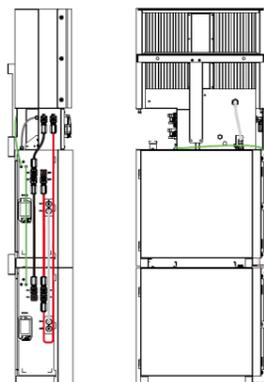
**Trin 5** Luk batteridækslerne og tilslut PV-MC4-stikkene til systemet (tilslut ion på begge sider).
