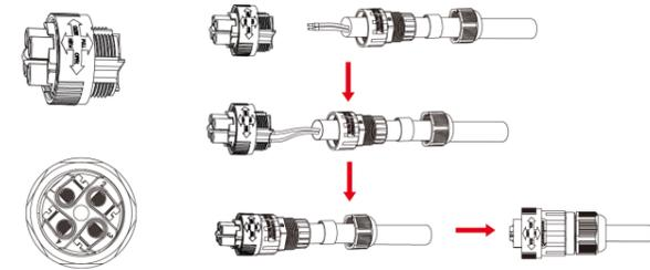
**Schritt 2** Installieren Sie die wasserdichte Komponente und schrauben Sie die wasserdichte Überwurfmutter auf.
