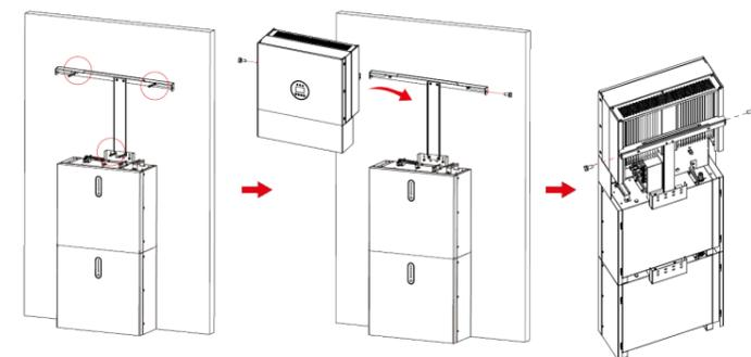
**Krok 1** Zavěste střídač na montážní panely, nastavte celý systém a ujistěte se, že baterie a střídač byly bezpečně zavěšeny na panely a držáky.
