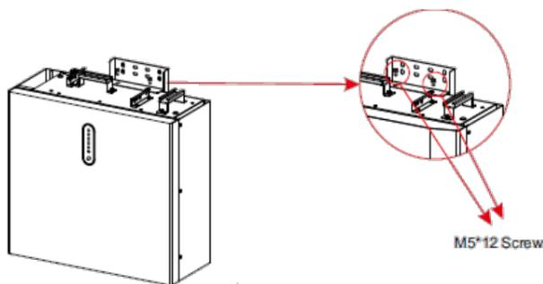
**Schritt 3** Positionieren Sie die Batterie parallel zur Wand und bohren Sie mit einem  $\Phi$  10-mm-Bohrer etwa 70 mm tiefe Löcher in die Wand für die spätere Befestigung der Montageplatten.
