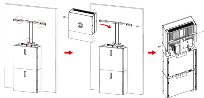
**Trin 1** Hæng inverteren på monteringsbeslagene, juster hele systemet og sørg for, at batteriet og inverteren er forsvarligt hængt på panelerne og beslagene.
