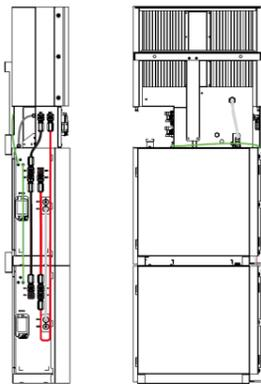
**Trinn 5** Lukk batteridekslene og koble PV-MC4-kontaktene til systemet (koble ion på begge sider).
