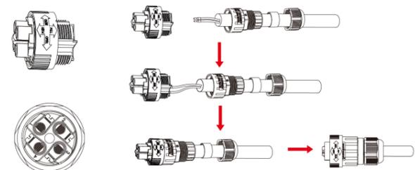
**Krok 2** Należy zainstalować element wodoodporny i przykręcić nakrętkę osłony wodoodpornej
