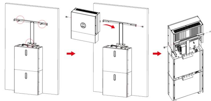
**Trinn 1** Heng vekselretteren på monteringspanelene, juster hele systemet og sørg for at batteriet og vekselretteren henger bra på panelene og brakettene.
