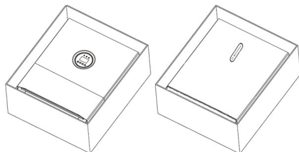
**Passo 2** Fissare il pannello di montaggio sulla batteria.
