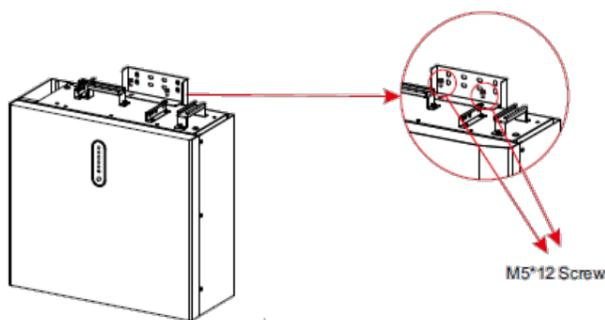
**Krok 3** Należy ustawić baterię równoległe do ściany i użyć wiertła  $\Phi 10$  mm, aby wywiercić otwory o głębokości około 70 mm w ścianie w celu późniejszego zamocowania płyt montażowych.
