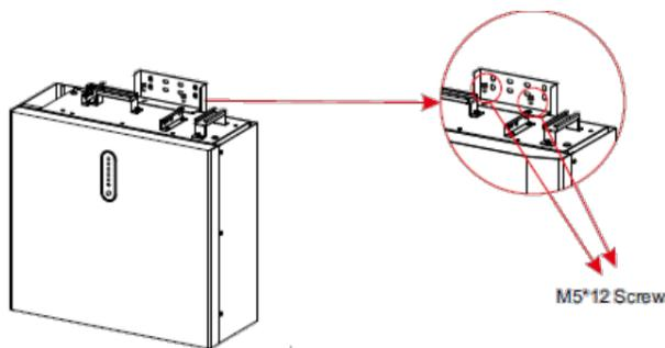
**Krok 3** Umístěte baterii rovnoběžně se stěnou a pomocí vrtáku  $\Phi 10$  mm vyvrtajte do stěny otvory o hloubce asi 70 mm pro následné upevnění montážních držáků.
