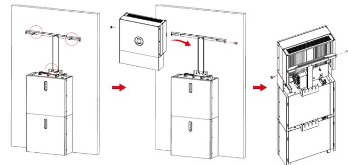
**Schritt 1** Hängen Sie den Wechselrichter an die Montageplatten, justieren Sie das gesamte System und vergewissern Sie sich, dass die Batterie und der Wechselrichter sicher an den Platten und Halterungen befestigt sind.
