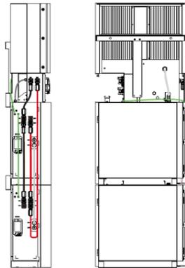
**krok 5** Zatvorte kryty batérií a pripojte konektory PV-MC4 k systému (zapojenie na oboch stranách).
