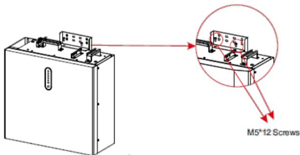
**Trinn 3** Plasser først systemets bunnstøtte(r) på bakken på installasjonsstedet, parallelt med veggen. Plasser deretter det laveste batteriet på denne bunnstøtten parallelt med veggen, og bruk et  $\Phi 10$  mm bor til å bore hull ca. 70 mm dype for å feste monteringsplatene. Hvis du har flere kolonner med batterier, må du gjenta dette trinnet for hver kolonne.
