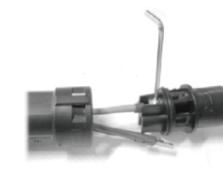
**Krok 4** Našroubujte otočnou matici na závitové pouzdro. Tím se utěsní konektor AC napájení a odlehčí se tah kabelu AC napájení. Přitom držte vložku pouzdra pevně za zajišťovací kryt. Tím je zajištěno, že otočnou matici lze pevně našroubovat na závitové pouzdro.
