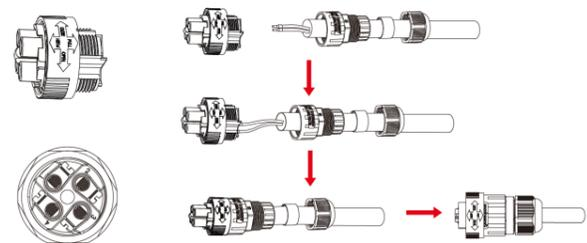
**Trin 2** Installer den vandtætte komponent og skru den vandtætte kappemøtrik på
