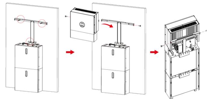
**Krok 1** Należy zawiesić falownik na panelach montażowych, wyregulować cały system i upewnić się, że bateria oraz inwerter zostały bezpiecznie zawieszony na panelach i wspornikach.
