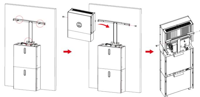
**Fase 1** Appendere l'inverter ai pannelli di montaggio, regolare l'intero sistema e assicurarsi che la batteria e l'inverter siano stati fissati saldamente ai pannelli e alle staffe.
