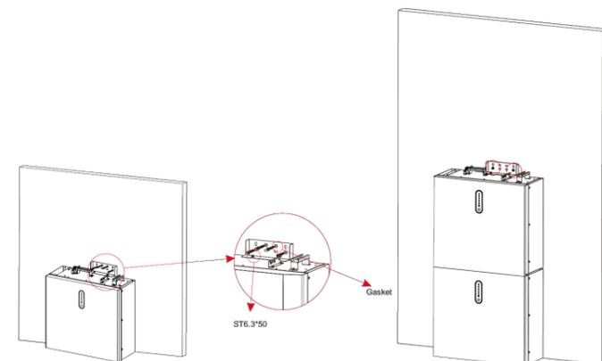
**Schritt 5** Wiederholen Sie die Schritte 2 und 3, um die zweite (und alle weiteren) Batterie zu montieren.
