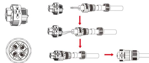
**Krok 2** Nainstalujte vodotěsnou část a našroubujte matici vodotěsného pláště
