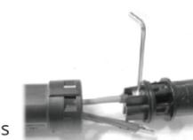
**Schritt 4** Schrauben Sie die Schwenkmutter auf die Gewindehülse. Dies dichtet den Wechselstromanschluss ab und sorgt für eine Zugentlastung des Wechselstromkabels. Halten Sie dabei den Buchseneinsatz an der Klemmkappe fest. Dadurch wird sichergestellt, dass die Schwenkmutter fest auf die Gewindehülse geschraubt werden kann.
