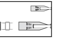
Setzen Sie das andere Ende der Nadel in den vorderen Stecker ein und befestigen Sie beide Seiten mit PVC-Kleber.
