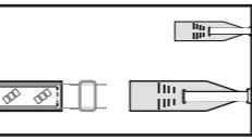
Inserire l'altra estremità dello spinotto al connettore anteriore e utilizzare la colla in PVC per fissare entrambi i lati.
