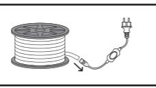
Togliere la spina del cavo di alimentazione della striscia led, rimuovere lentamente il spinotto a 2 pin, colla in PVC.
