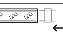
Sätt en ändhant (med pvc-lim i den för att skapa en förseglning) på änden av LED-listen.
