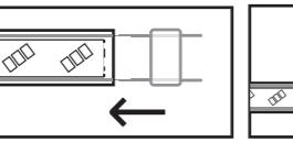
Setzen Sie eine 2-polige Nadel in die Feder ein (die um den Draht herum liegt).
