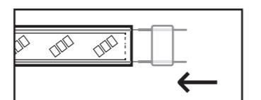
Setzen Sie eine 2-polige Nadel in die Feder ein (die um den Draht herum liegt).
