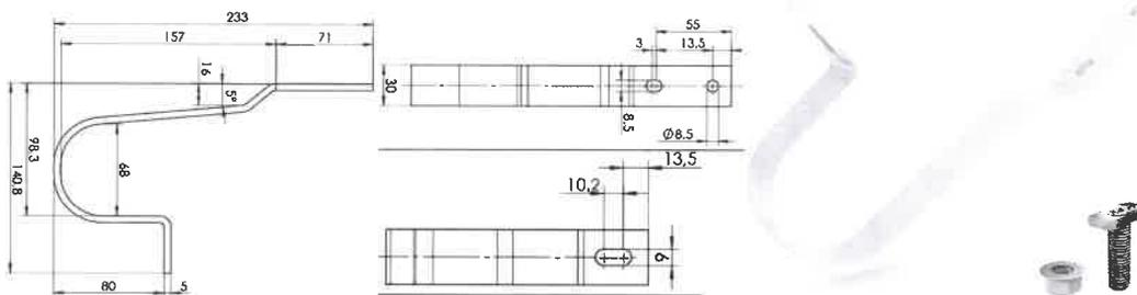
Crochet en acier inoxydable pour la fixation du SingleRail sur tuiles plates. Y compris vis à tête marteau (acier inox A2) et écrous à embase avec cran d'arrêt (acier inox A2) - Matériau : Acier Inox
