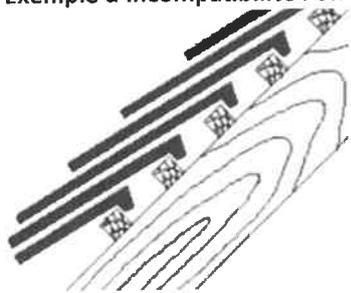
❖ **AVEC LES CROCHETS DESTINES AUX COUVERTURES EN TUILES EN BETON à emboîtement à pureau plat – (Crochets SingleHook 2)**
