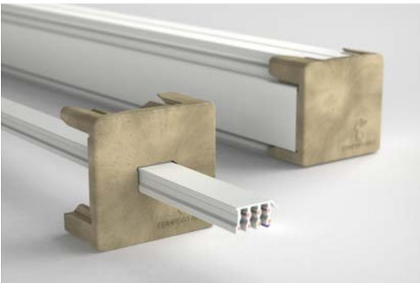
Les embouts de protection de l'emballage des rails porteurs comportent une aide à la découpe intégrée qui permet de procéder à des ajustements de la longueur de l'alimentation sur site. Par ailleurs, les guides d'emballage et de découpe multifonctions sont constitués d'un mélange compostable à base d'algues marines, de fibres de cellulose de bois, de craie et d'eau.
