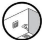
Le thermostat ne doit pas être installé dans des zones humides directes (Zones 0, 1 et 2). Respectez toujours les règlements locaux concernant les classes IP, cela ne signifie pas que les thermostats ne peuvent pas être installés dans les salles de bains.
