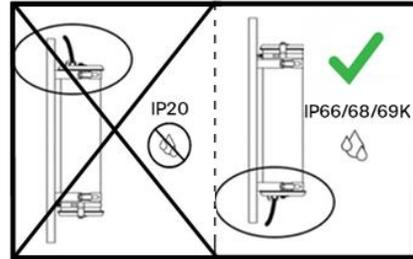
Vérifier impérativement la correcte fermeture des organes d'étanchéité du produit, y compris pour les produits livrés précâblés.
