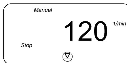
Fig. 12 Affichage : symbole de signal de réservoir vide
