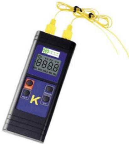
Le thermomètre thermocouple MGT412 peut mesurer la température de  $-50 \sim 1300^{\circ}\text{C}$  via le capteur de température thermocouple de type K. Il a la double entrée à deux canaux du thermocouple K.
