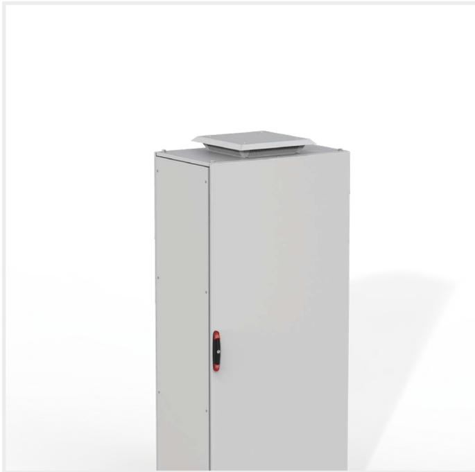
Ce ventilateur à filtre de toit, RFU, avec un indice de protection IP 33 ou 54, se monte facilement sur le toit de l'armoire grâce à une fonction enclipsable. Ainsi, il n'y a pas besoin d'utiliser la surface sur la porte. La défaillance des composants et les temps d'arrêt sont éliminés car l'eau et la poussière ne peuvent pas pénétrer dans l'armoire. Le moteur fiable du ventilateur à filtre garantit une ventilation constante dans chaque armoire sur laquelle le ventilateur est installé.
