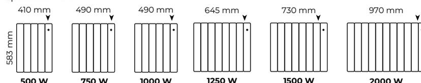
► Emplacement du boîtier de commande sur l'appareil
