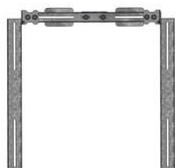
Sistema di fissaggio con fori oblunghi
