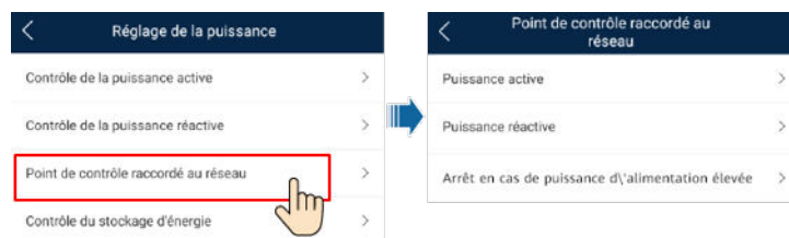
Figure 7-8 Point de contrôle raccordé au réseau
