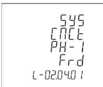
Le sens du courant L1 peut être réglé « en avant » (Frd) ou « en arrière » (rE!).
