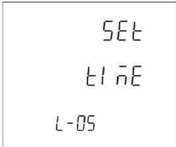
2. Durée de rétroéclairage de l'afficheur (Page L-05.01)
