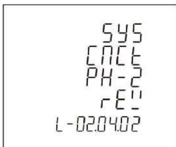
Le sens du courant L2 peut être réglé « en avant » (F r d) ou « en arrière » (r E -).
