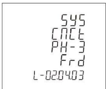
Le sens du courant L3 peut être réglé « en avant » (F r d) ou « en arrière » (r E -).
