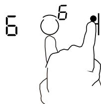
2. Schalten Sie die Kochzone aus, indem Sie den Slider berühren. Stellen Sie sicher, dass die Anzeige „0“ zeigt.
