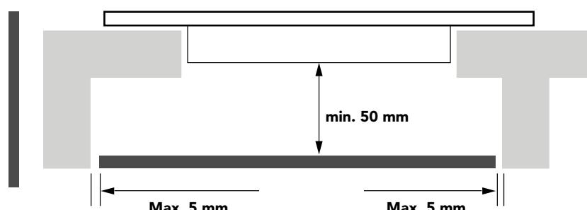
**⚠️ Rund um das Kochfeld befinden sich Lüftungsöffnungen. Diese Öffnungen dürfen beim Einbau des Kochfelds nicht von der Arbeitsplatte blockiert werden.**
