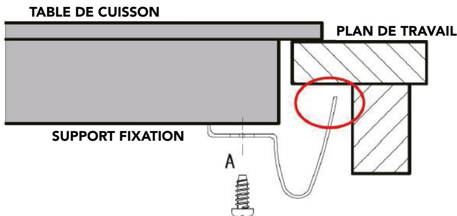
**⚠️ Attention :** Les supports (en métal, illustrés en détail à droite de l'image) ne doivent pas toucher les surfaces intérieures du plan de travail indiquées par le cercle rouge sur le schéma.
