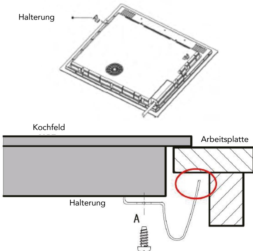
**⚠️** Onder geen enkele omstandigheid mogen de beugels na installatie de binnenoppervlakken van het werkblad raken (zie afbeelding).
