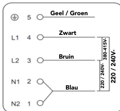
**!** Als het geselecteerde apparaat minstens 4 kookzones heeft, kan het direct via een enkelfasige elektrische verbinding op het stroomnet worden aangesloten (zie afbeelding).
