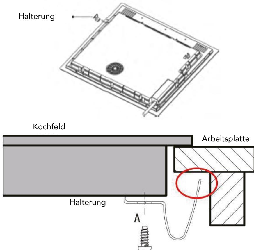
**⚠** Unter keinen Umständen dürfen die Halterungen nach der Installation die inneren Flächen der Arbeitsplatte berühren (siehe Abbildung).
