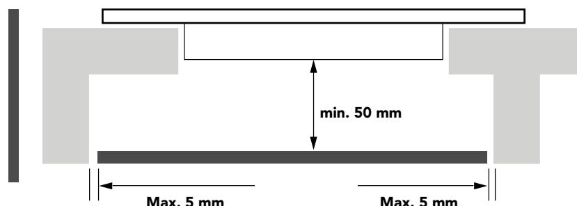
**⚠️ Rondom de kookplaat bevinden zich ventilatieopeningen. Deze openingen mogen bij de installatie van de kookplaat niet door het werkblad worden geblokkeerd.**
