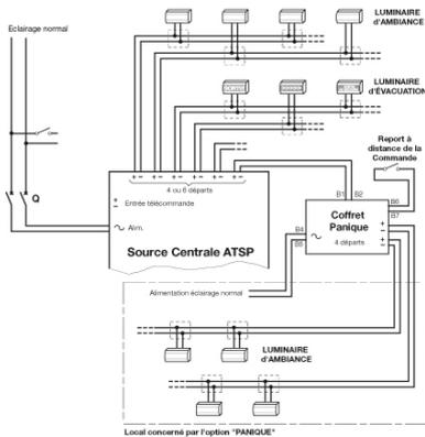
Associé à une source centrale permanente, il permet de commuter l'éclairage d'ambiance (anti-panique) PERMANENT en mode NON PERMANENT .
