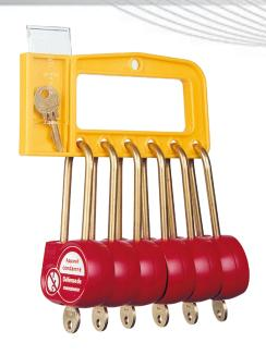
La condamnation a pour but d'interdire la manœuvre d'un organe de séparation (ex : un disjoncteur). Elle comprend une immobilisation par un blocage mécanique de l'organe et une signalisation. Le cadenas de condamnation assure pleinement cette fonction avec, en plus, la sécurité d'être déposé et enlevé par une personne compétente, le chargé de consignation.
