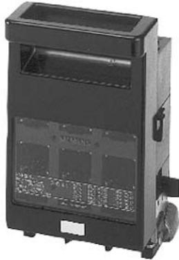
SENTRON, fusible-interrupteur-sectionneur 3NP5, 3 pôles, NH00, 160 A, pour Montage et encastrement sur plaque de montage, avec Enclenchement brusque, étrier de serrage, Interrupteur auxiliaire sur interrupteur-sectionneur : 1 contact à fermeture+1 contact à ouverture,
