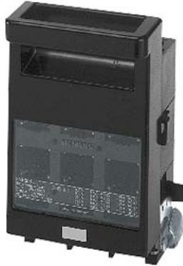
SENTRON, fusible-interrupteur-sectionneur 3NP5, 3 pôles, NH00, 160 A, avec adaptateur pour Système de jeu de barres 8US 40mm avec enclenchement brusque, borne à vis, interrupteur auxiliaire sur l'interrupteur-sectionneur : 1 contact à fermeture+1 contact à ouverture,
