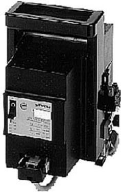
SENTRON, fusible-interrupteur-sectionneur 3NP5, 3 pôles, NH00, 160 A, avec adaptateur pour Système de jeu de barres 8US 40mm avec enclenchement brusque, étrier de serrage, surveillance de fusible : l'intégration 3VU, Interrupteur auxiliaire sur interrupteur-sectionneur : 1 NO +1 NF Interrupteur auxiliaire sur surveillance de fusible : 2 contacts à fermeture
