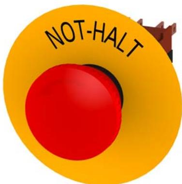
Bouton-poussoir coup de poing d'arrêt d'urgence 16 mm, rond, plastique, rouge, à accrochage, avec déverrouillage par rotation, selon ISO 13850, 1 NF, avec étiquette sous collerette jaune, ARRÊT D'URGENCE
