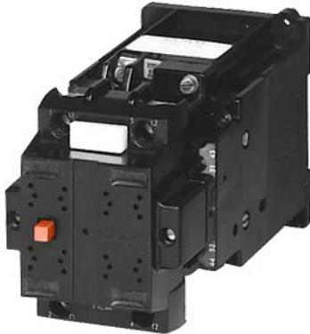
contacteur, taille 2, 2 points, 3 et 5 CC, 32A Contacts auxiliaires 22 (2 NO + 2 NC) 24V CC circuit de commande DC Plage de travail 0,85-1,1 UN
