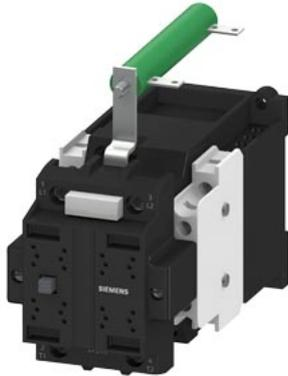
contacteur, taille 2, 2 points, pour applications ferroviaires 3 et 5 CC, 7,5 A pour 750 V 24 V CC Contacts auxiliaires 21 (2 NO+1 NF) avec varistance et résistance série Plage de travail 0,7...1,25 x US Plage de travail 0,7...1,25 x US
