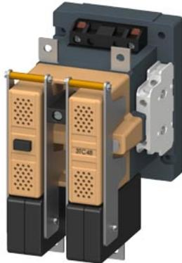
contacteur, Taille 4, 2 points, 3 et 5 CC, 75A Interrupteur auxiliaire 22 (2 NO + 2 NC) 230 V CA 50 Hz, 277V 60Hz actionnement CA
