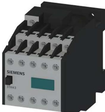
Contacteur auxiliaire, 91E, EN 50011, 9 NO + 1 NF, borne à vis, Commande CA, AC 24V 50Hz/AC 29V 60Hz
