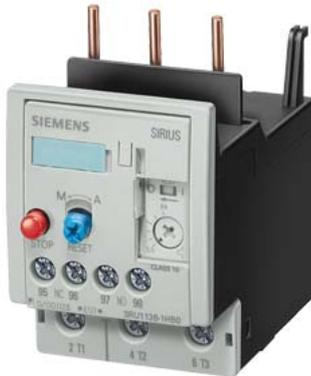
Relais de surcharge 7...10 A pour protection des moteurs taille S2, CLASS 10 Montage sur contacteur circuit principal : bornes à vis circuit auxiliaire : bornes à vis Réarmement automatique/manuel !!! Produit en fin de vie !! Le successeur est SIRIUS 3RU2 Successeur préféré : >>3RU2126-1JB0<<
