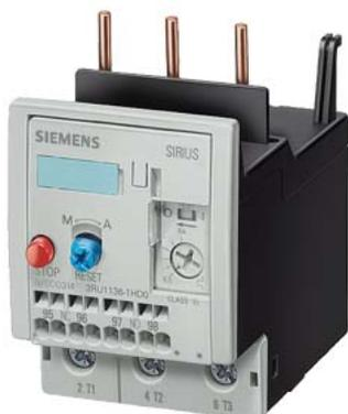
Relais de surcharge 18...25 A pour protection des moteurs taille S2, CLASS 10 Montage sur contacteur circuit principal : bornes à vis circuit auxiliaire : bornes à ressort Réarmement automatique/manuel !!! Produit en fin de vie !! Le successeur est SIRIUS 3RU2 Successeur préféré : >>3RU2136-4DD0<<
