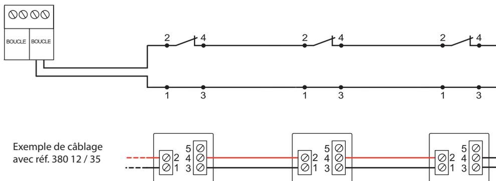
Raccorder tous les déclencheurs manuels sur un même câble lorsqu'ils font partie d'une même boucle.
