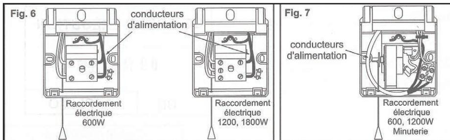
**ATTENTION : ne pas abîmer les conducteur électriques avec les vis de fixation murale du boîtier de commande**
