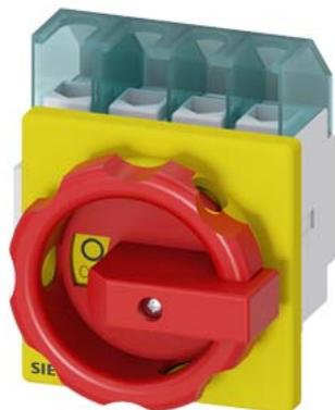
SENTRON, interrupteur-sectionneur 3LD, interrupteur de coupure d'urgence, 4- pôles, lu : 25A, Puissance de service / avec AC-23 A pour 400V : 9,5 kW, fixé à l'avant, commande rotative, rouge/jaune, Fixation par 4 trous de l'organe de commande
