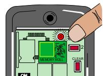
**I** NOTA 2: La schedina Memory Roll deve essere inserita **solo** per le procedure di trasferimento dati da e per il ricevitore RE432-RC.
