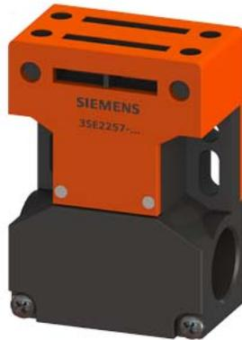
interrupteur de position de sécurité à détrompeur séparé plastique, boîtier court, 3x(M20x1,5), actionnement latéral et frontal, contacts à action dépendante 1 NF, force d'extraction 30 N, livraison sans détrompeur,
