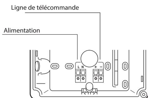
Raccorder les 2 fils d'alimentation sur les bornes
