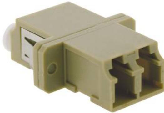
Les raccords optiques (ou traversées de cloison) permettent de connecter deux fibres munies de connecteurs (fibres optiques préconnectorisées, jarretières optiques ...) entre elles, via un centreur d'alignement. Ce procédé permet de garantir une perte d'insertion et une réflectance optimisées au point de contact.
