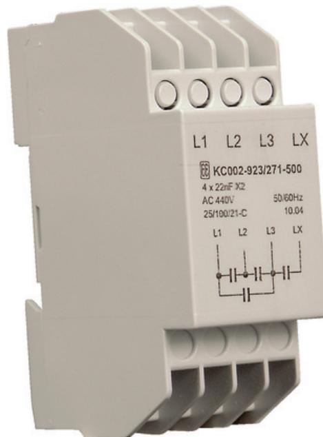
Coupleur de phase pour réseau sur Courant Porteur (CPL) à montage sur rail DIN. Les coupleurs de phase sont utilisés dans le cas d'installations triphasées pour permettre aux signaux CPL de se propager d'une phase à l'autre.
