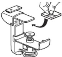
Permet la fixation des blocs sur bureau épaisseur 60mm maxi
