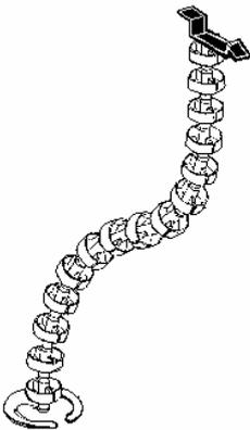
Permet de guider les câbles verticalement sous le bureau (passage d'une boîte de sol à un bloc bureau)
