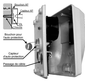
La SIREX se fixe sur une paroi verticale et plane de surface supérieure à celle de son boîtier en laissant au moins 2cm de chaque côté. Percez les trous de fixation en suivant le gabarit de perçage, puis fixez en premier la pièce plastique en forme de bouchon sur le mur. Ensuite positionnez le châssis de la SIREX en prenant soin de bien placer le capteur de surveillance d'arrachement à l'intérieur du bouchon plastique. Ce système ne nécessite aucun réglage.
