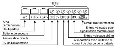
Toutes les connexions sont de niveau TBTS (Très basse tension de sécurité) au sens de la norme EN 60950. L'alimentation électrique de la SIREX doit être fournie par une source à puissance limitée.
