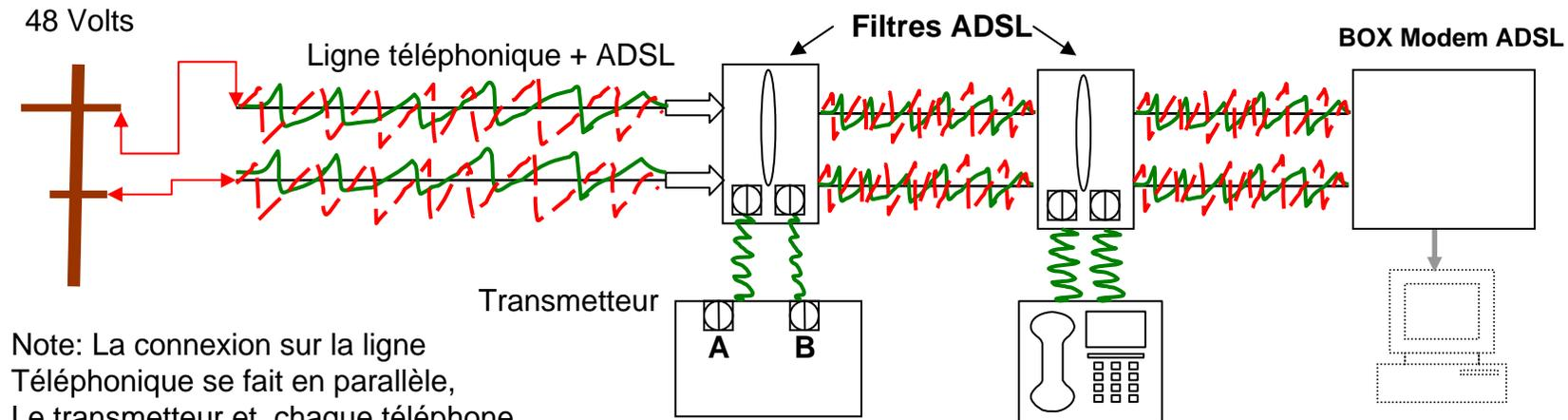
Note: La connexion sur la ligne Téléphonique se fait en parallèle, Le transmetteur et chaque téléphone doit être équipés d'un filtre ADSL.
